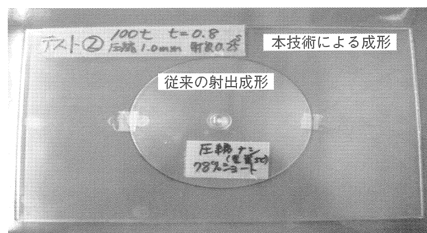
図 6 本技術と従来の射出成形での樹脂充填の違い (PC、サイズ 316×211 mm、板厚 0.8 mm の場合)。円盤状成形品が従来の射出成形、長方形成形品が本技術による成形 (フル充填)
