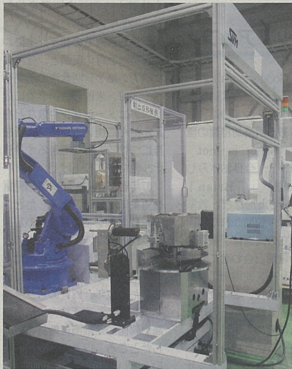
自動でバリ取りなどを可能にした、樹脂成形品向けの無人2次加工機 群馬県伊勢崎市
