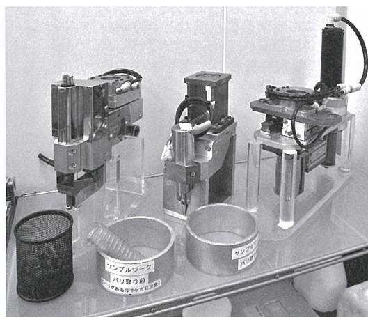
切断理論が活かされている超音波カッター
