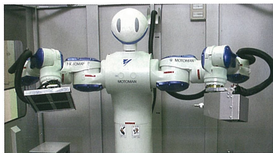
樹脂成形からバリ処理まで一貫して無人化できる双腕ロボ型自動バリ取り装置。
