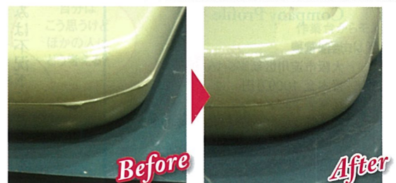
バリを削る前は、金型の合わせ目から素材がはみ出ている。バリを削った後は合わせ目が滑らかに
