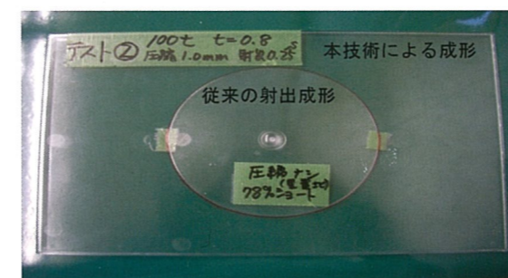
図2 本技術と従来の射出成形での樹脂充填の違い 円盤状成形品が従来の射出成形、長方形成形品が本技術による成形
