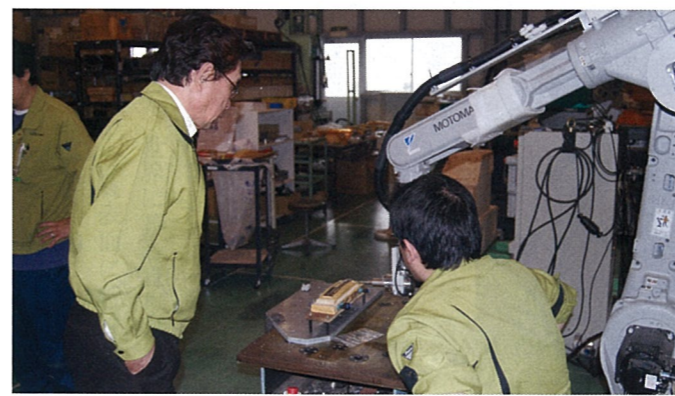
カットする商品に合わせてロボットの動きをプログラムするティーチングが難しい。多関節ロボット、頑丈鋭利なハイスピード鋼の刃を自在に動かすカギはソフトにある
