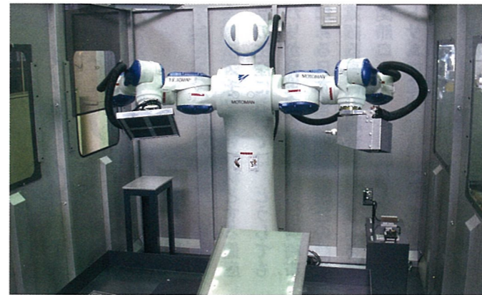
最新の低加圧射出成形システム用の最新ロボット。炭素繊維など最高硬度のカーボンでスパッと斬る
